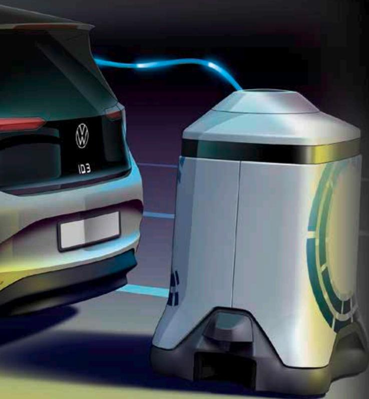
Der Laderoboter von VW soll künftig Elektroautos in Parkhäusern oder Tiefgaragen mit Strom versorgen. Er bringt einen fahrbaren Energiespeicher zum Wagen, der diesen auflädt – und kümmert sich derweil schon um das nächste Fahrzeug.
